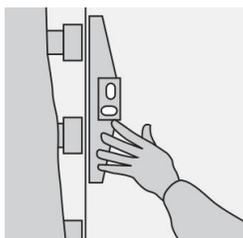
Se a parede o permitir, pregue directamente os suportes. Se não, cole ou aparafuse. Seja qual for o modo de fixação escolhido, verifique cuidadosamente a verticalidade da parede com um nível ou fio-de-prumo e corrija as eventuais diferenças de nível colocando uma cunha de madeira atrás dos suportes antes da sua fixação.
